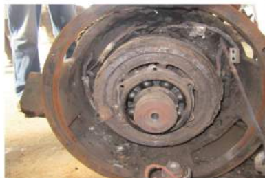
Foto – conductorul de legătură între polul principal și auxiliar secționat
