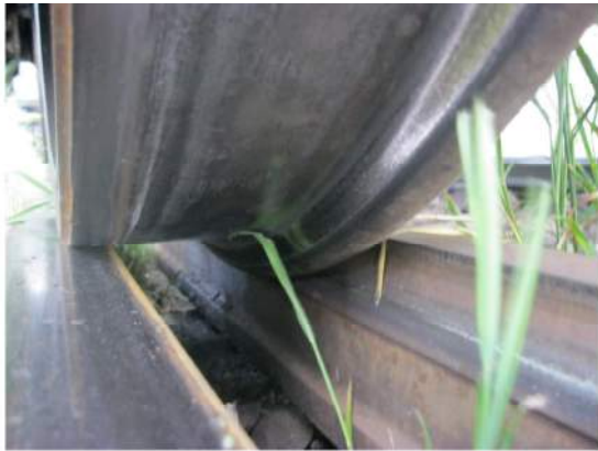
foto nr. 13 – axia nr. 3 sens de mers a vagonului oprit pe zona deraierii – partea dreaptă
