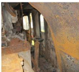
Efectul arderii în interiorul sălii mașinii
