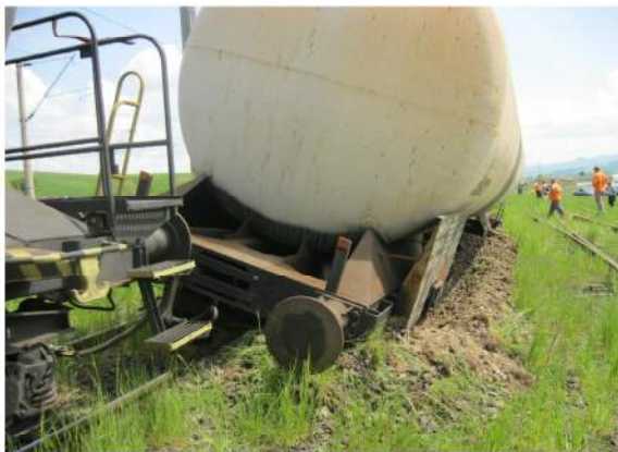
foto nr. 14 – tamponele din față ale vagonului deraiat
