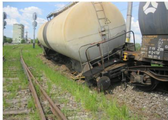
foto nr. 15 – tamponaie din spate ale vagonului deraiat
