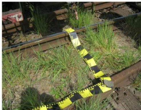
foto nr. 7 - distanța maximă a urmei de deraiere față de linia normală de circulație
