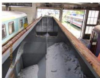
Foto 3: Compartimentul din spate partea dreaptă a sensului de mers rămas nedescărcat la primul boghiu în sensul de mers
