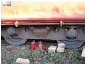
Foto 2 : Vagonul nr. 31530667181-1 deraiat
