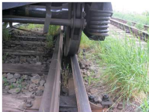
foto nr. 12 – boghiul nr. 2 al vagonului aflat pe locul cu primele urme de deraiere – partea dreaptă
